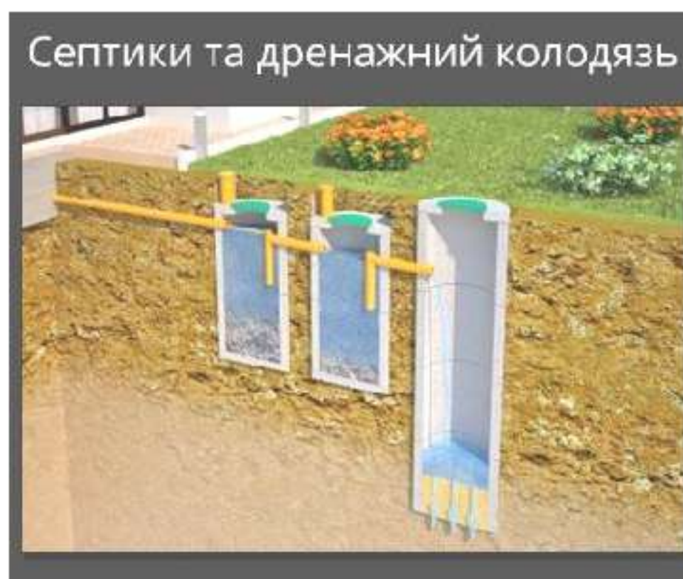
Септики та дренажний колодезь мал. Облаштування дренажного колодезя
